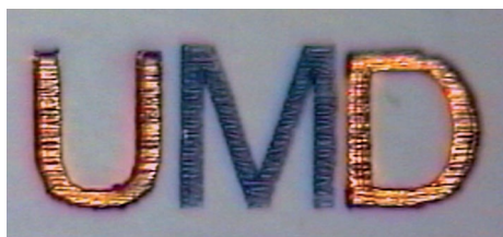
Abbildung 9. Selektive Metallbeschichtung mit MAP hergestellter Mikrostrukturen. Das „U“ und das „D“ wurden aus einem Acrylatpolymer hergestellt, das „M“ aus einem Methacrylatpolymer. Kupfer wurde selektiv auf den Acrylatstrukturen abgeschieden.
